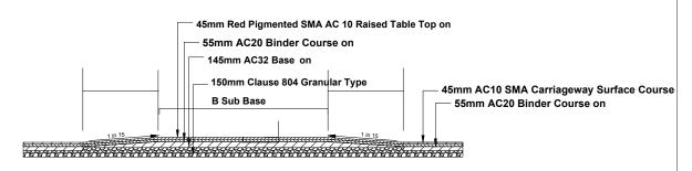
A-A TYPICAL FLAT TOP RAMP SECTION
